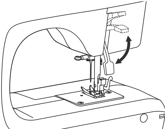
Beim Nähen von extrem dicken Stoffen kann der Stoffdurchgang unter dem Nähfuß vergrößert werden, indem man den Zweistufen-Nähfußhebel (18) weiter anhebt (Pfeil).
