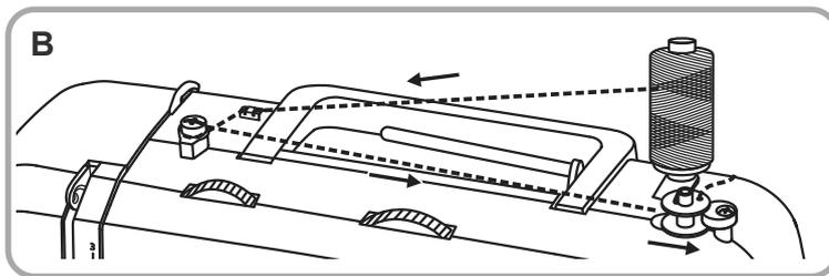
Faden von innen durch ein Loch der leeren Spule (g) nach außen ziehen. Spule auf die Spuleinrichtung (14) stecken und dann nach rechts in die Spulposition drücken.
