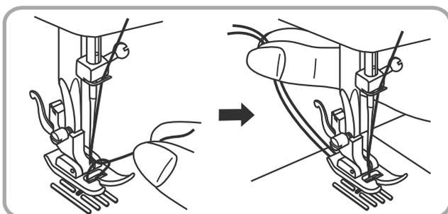
Am Oberfaden ziehen, damit der Unterfaden aus dem Stichloch gezogen wird. Beide Fäden unter dem Nähfuß nach hinten legen.
