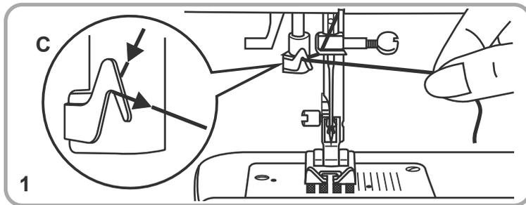
1. Senken Sie den Nähfuß ab. Führen Sie den Faden entlang der Fadenführung (C).
