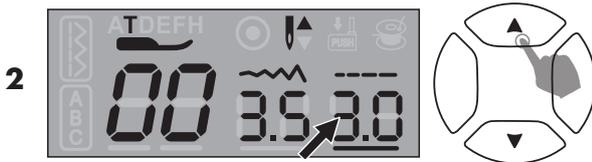
2. Drücken Sie für eine geringere Stichlänge die Abwärtstaste. Drücken Sie für eine größere Stichlänge die Aufwärtstaste.
