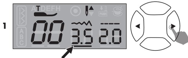
1. Verschieben Sie den Cursor mit der Links- oder Rechtstaste unter die Ziffern des Stichbreitenwerts.
