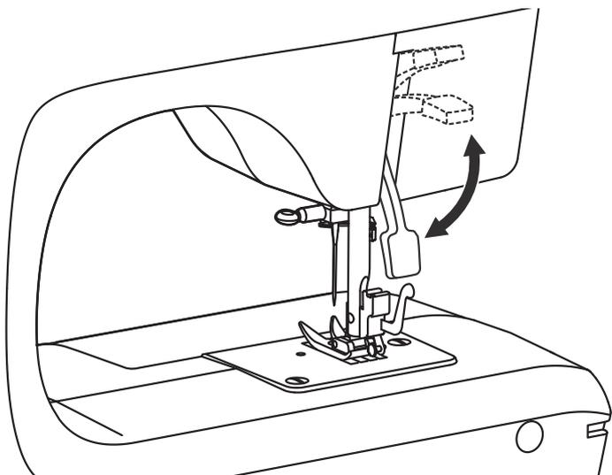
Para coser telas extremadamente gruesas, se puede ensanchar el paso de la tela debajo del prensateles levantando más la palanca del prensateles de dos posiciones (18).
