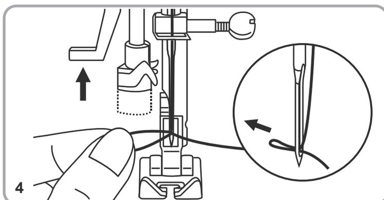
4. Mantenga el hilo suelto y suelte la palanca lentamente. El gancho girará y pasará el hilo a través del ojo de la aguja, con lo cual formará un lazo. Pase el hilo por el ojo de la aguja.
