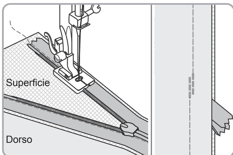
Para coser la otra mitad de la cremallera, sujete con alfileres la parte de abajo con los dientes en la costura (1,58 centímetros) deteniéndose a 2 centímetros del borde de la tela, como antes. Asegúrese de que la cremallera no está torcida en la parte inferior. Use el carril izquierdo del prensatelas y asegúrese de que la marca central sigue alineada con la aguja y la puntada, como antes.
