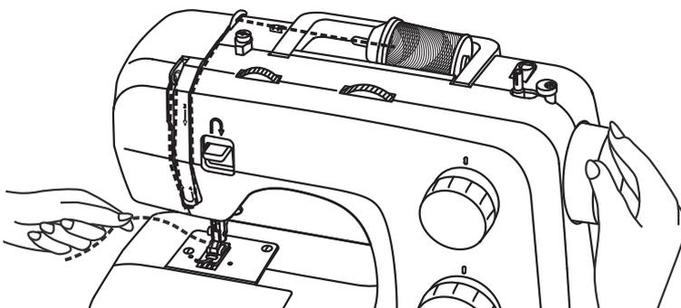
Sujetar la punta del hilo superior con la mano. Girar el volante (21) en el sentido contrario al de las agujas del reloj hasta que la aguja esté nuevamente en su posición más alta (dar una vuelta completa).
