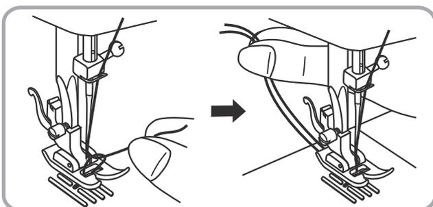
Tirar del hilo superior para que el hilo inferior suba a través del orificio de la placa de la aguja. Llevar los dos hilos hacia atrás, por debajo del prensatelas.
