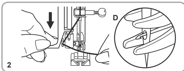
2. Presione la palanca hacia abajo todo lo que pueda. El enhebrador de agujas gira automáticamente a la posición de enhebrado y el pasador de enganche pasa a través del ojo de la aguja (D).
