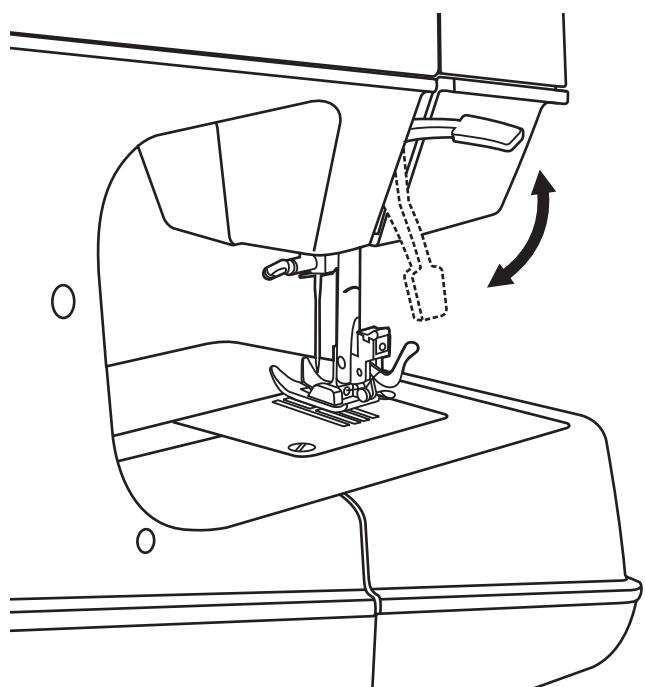
Για ράψιμο πολλών στρωμάτων υφάσματος ή χοντρών υφασμάτων, μπορείτε να σηκώσετε το πόδι στριφώματος και να διευκολύνετε την δίοδο του υφάσματος, σταθεροποιώντας το σε μια δεύτερη εγκοπή (18). (Βέλος)
